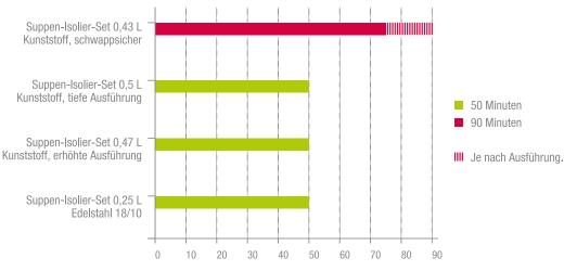
Noch längere Standzeiten sind im geteilten Transportwagen möglich. Oben stehende Zeitangaben sind Richtwerte im Alltagsbetrieb einer Krankenhausküche bei 24–28 °C Raumtemperatur. Vorausgesetzt werden Einfülltemperaturen von ca. 80 °C und eine Verzehrtemperatur von mindestens 65 °C.
